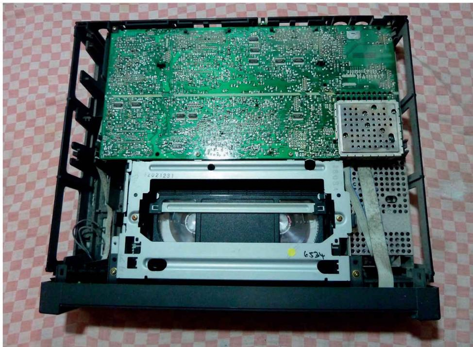
Figure 7-29. Intérieur d'un magnétoscope VHS
