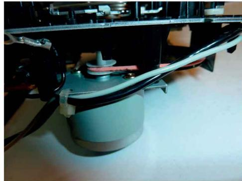
Figure 7-15. Courroie cassée et collée sur sa poulie, remplacée à droite
