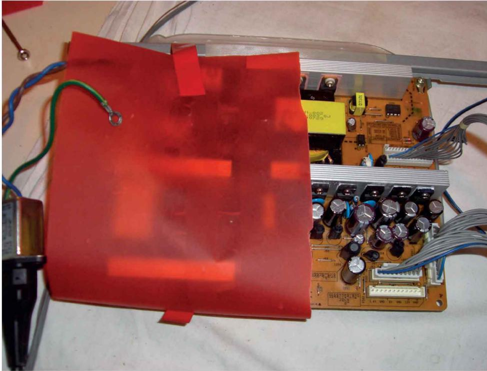
Figure 1-1. Protection d'une alimentation en cours de dépannage
