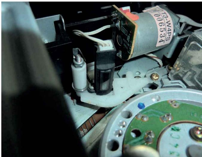
Figure 7-30. Tête d'effacement de magnétoscope VHS
