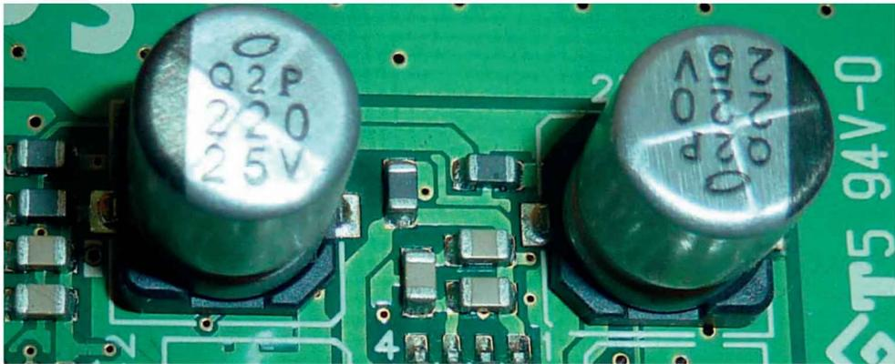
Figure 9-12. Condensateurs électrochimiques de type « Capsule CMS »
