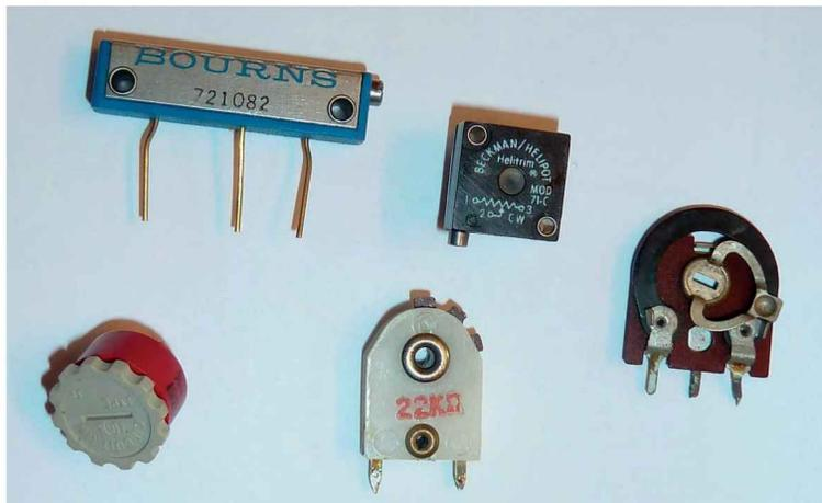
Figure 9-43. Potentiomètres ajustables
