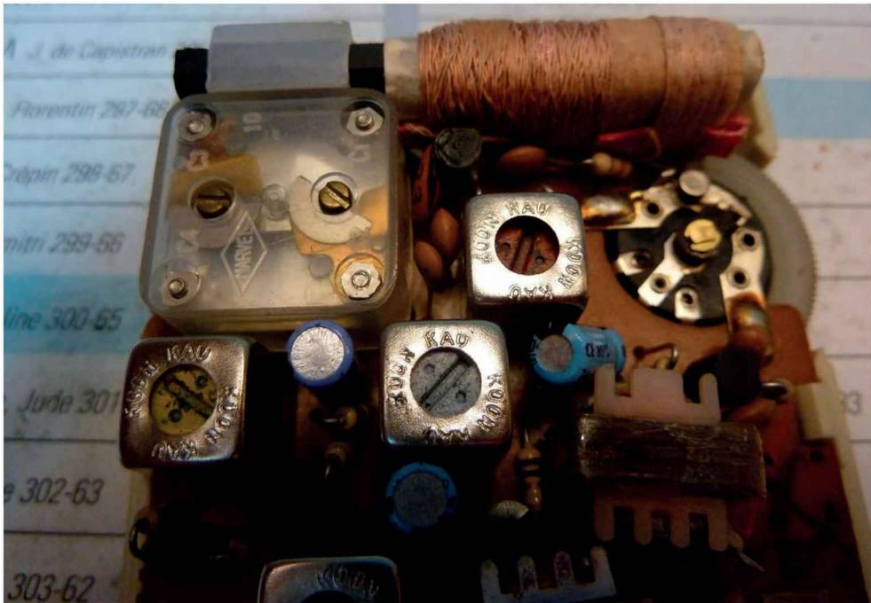
Figure 9-46. Condensateur variable muni de condensateurs ajustables (miniradio)
