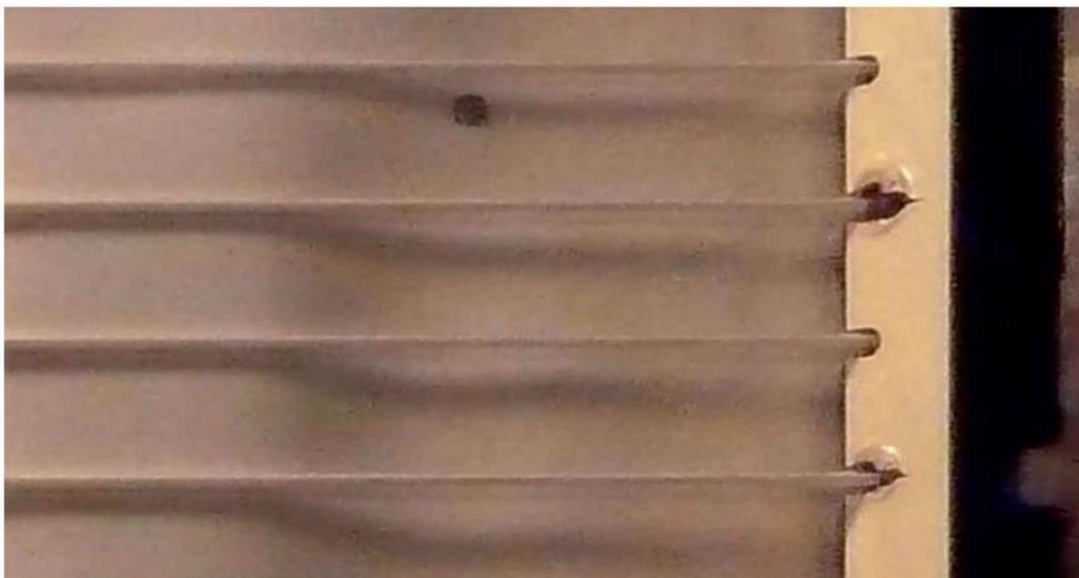
Figure 4-49. Échauffement du cache plastique d'un écran LCD au niveau connexion des tubes
