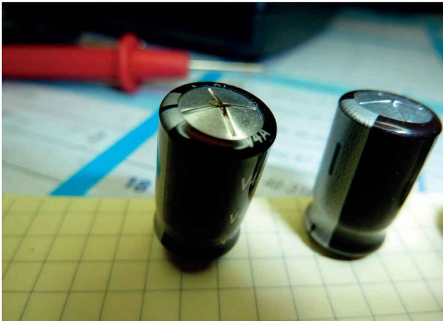
Figure 4-17. Condensateur gonflé à gauche, normal à droite
