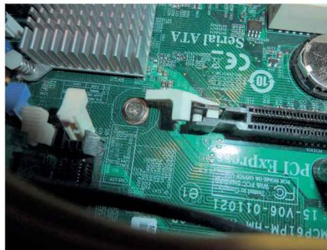
Figure 6-4. Carte vidéo démontée (notez l'ergot et le verrou du connecteur)
