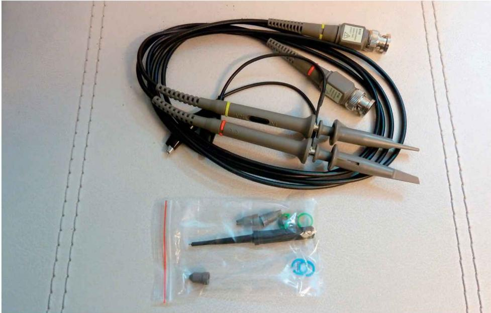
Figure 2-8. Sondes pour oscilloscope (diviseur par 1 et 10)
