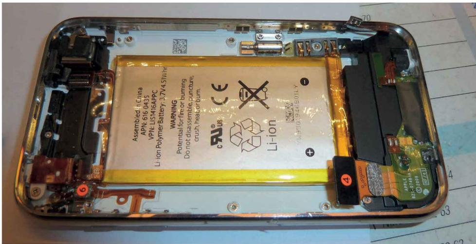
Figure 7-6. Démontage d'un smartphone doté d'un logo bien connu en vue de remplacer sa batterie
