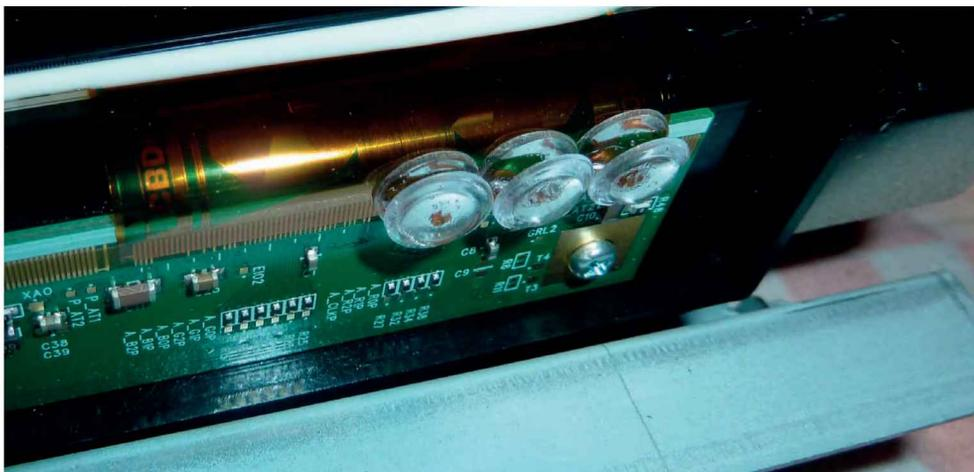
Figure 4-53. Mise en place de pastilles de pression sur une soudeure circuit imprimé-film
