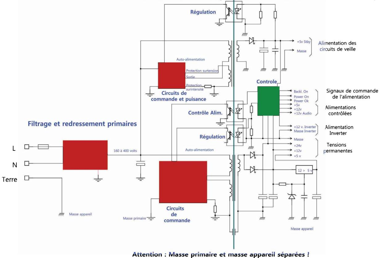
Figure 4-13. Synoptique d'une alimentation à découpage de téléviseur à inverter séparé
