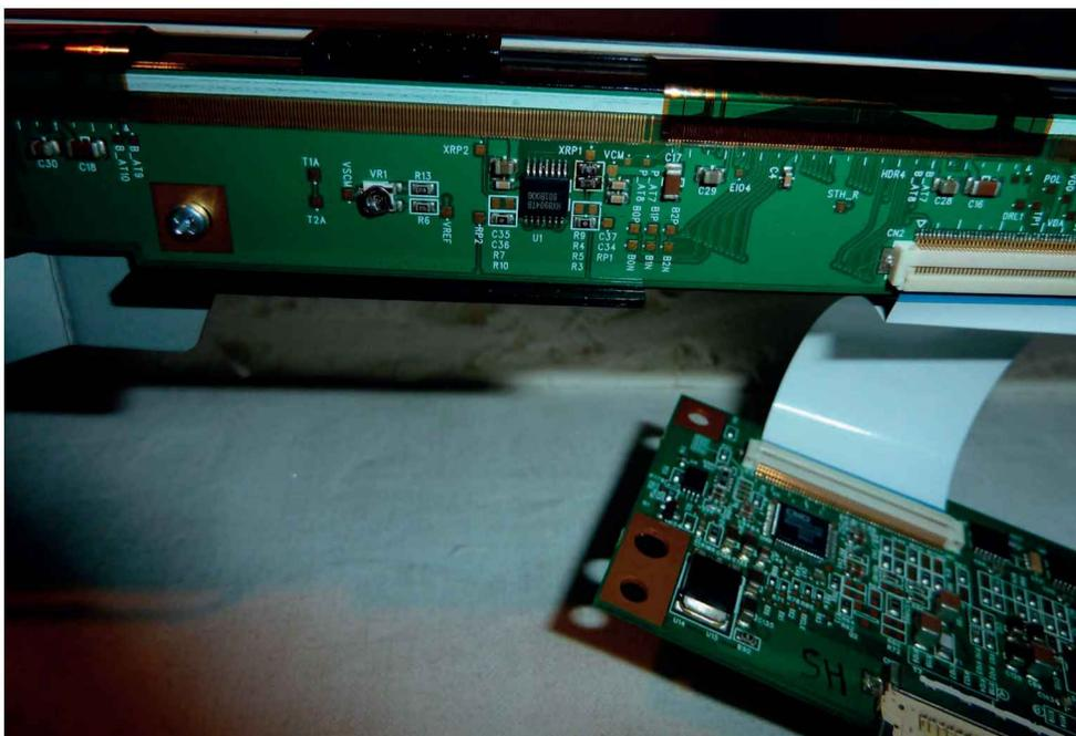
Figure 9-23. Connexion par câble plat (dalle écran LCD)
