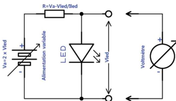
**La tension mesurée doit être proche de la tension nominale de la diode LED pour l'intensité nominale et sa brillance normale.**
