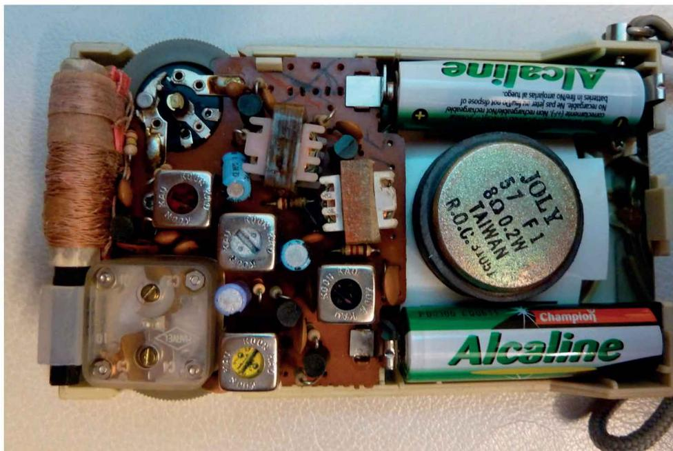
Figure 7-10. Petite radio à six transistors
