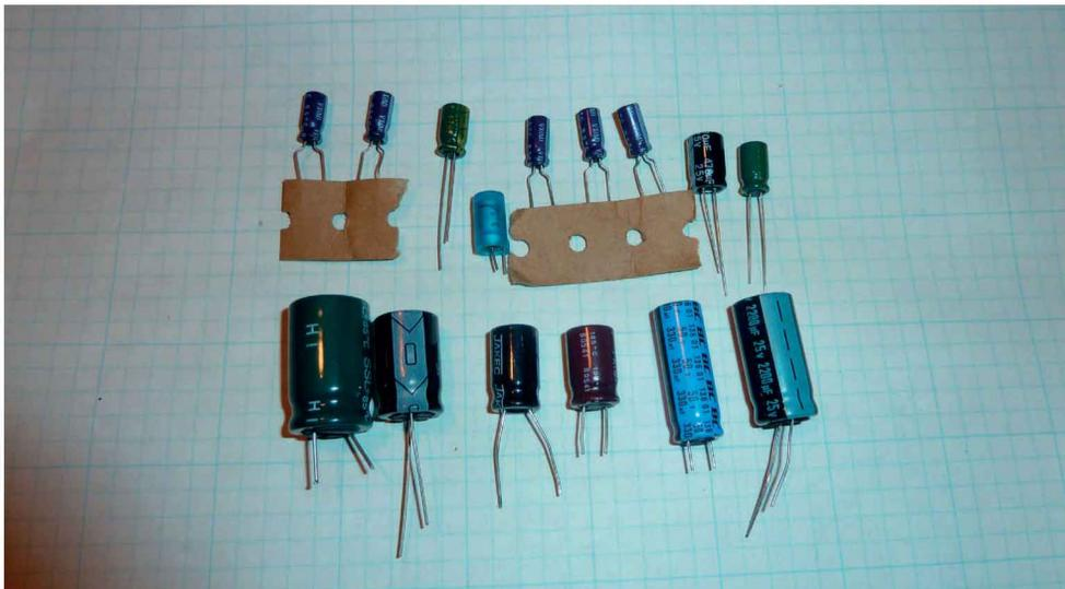
Figure 9-11. Condensateurs électrochimiques axiaux courants
