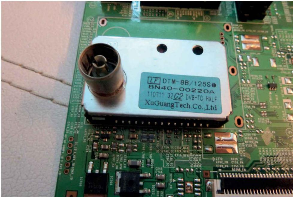
Figure 4-39. Tuner reconnaissable à sa prise antenne
