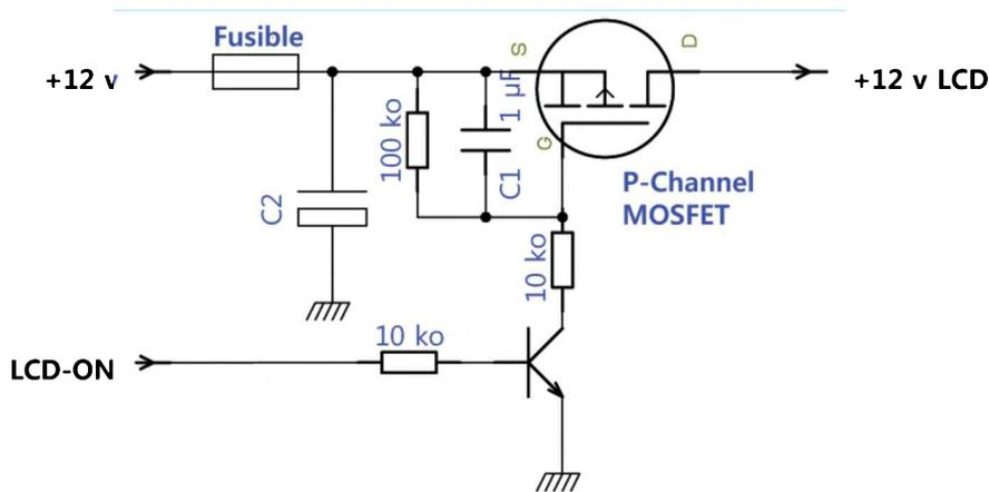
Figure 4-36. Circuit de coupure d'alimentation d'une dalle LCD
