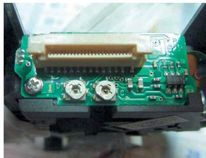
Figure 7-23. Potentiomètres de réglage (CD à gauche, CD/DVD à droite)
