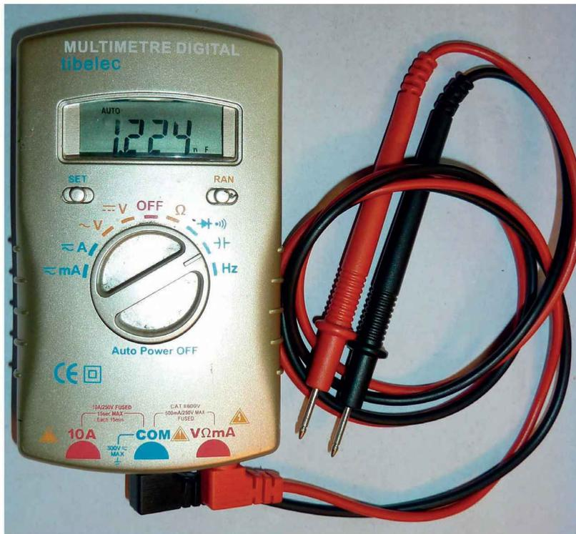
Figure 2-4. Multimètre numérique
