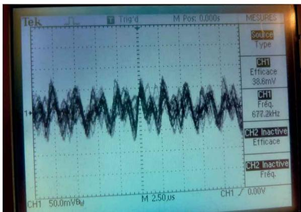
Figure 4-15. Bruit admissible sur une alimentation de 5 volts
