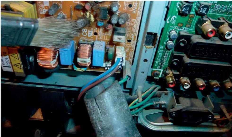
Figure 4-6. Nettoyage au pinceau et aspirateur
