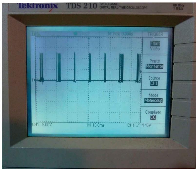
Figure 8-6. Trains d'impulsions sur une alimentation en court-circuit
