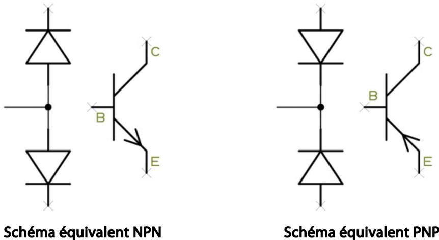
Figure 10-7. Schémas équivalents simplifiés d'un transistor
