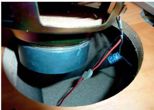
Figure 7-21. Condensateur de connexion vers le tweeter
