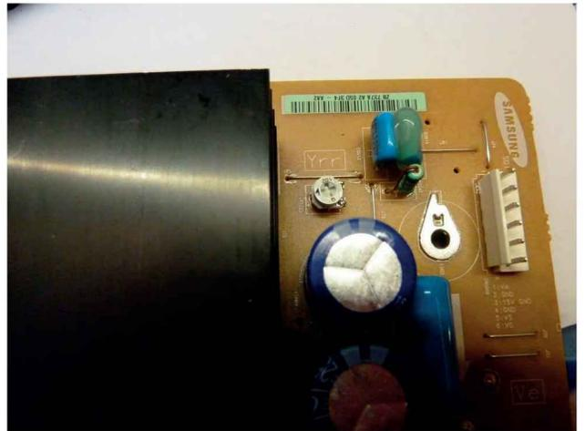
Figure 5-18. Réglage de la forme des signaux d'effacement Y-scan
