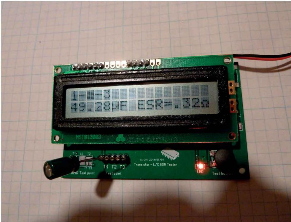
Figure 11-2. Contrôle d'un condensateur électrochimique de 47 µF 16 volts
