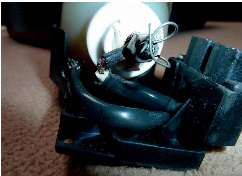
Figure 7-38. Connexion de lampe ayant surchauffé
