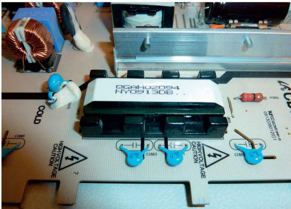
Figure 9-19. Transformateur d'un circuit inverter pour téléviseur LCD
