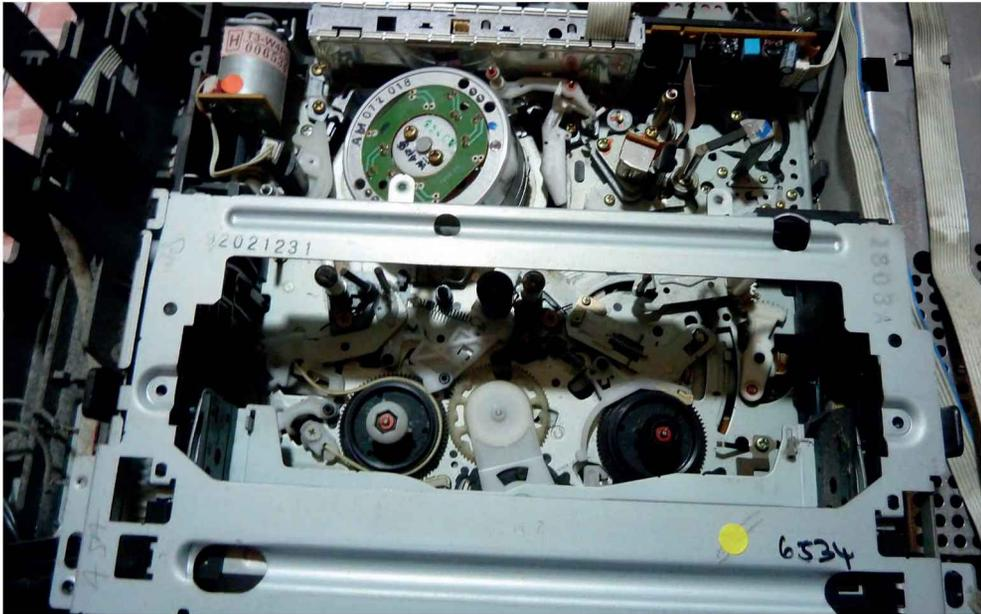
Figure 7-33. Mécanisme d'un magnétoscope VHS
