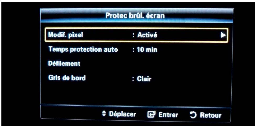
Figure 5-32. Option de protection antimarquage d'un téléviseur plasma
