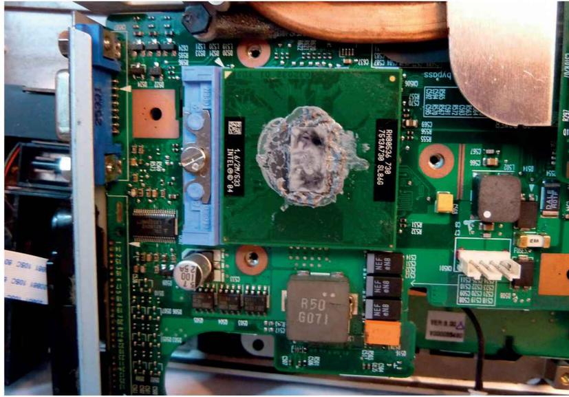
Figure 6-32. Vieillesse de la pâte thermique d'un microprocesseur
