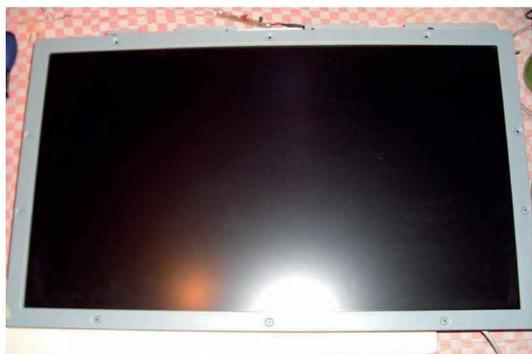
Figure 4-8. Téléviseur démonté, dalle à plat avec circuits en dessous et clavier de commande
