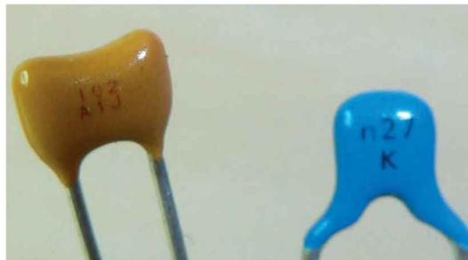
Figure 12-4. Exemples de marquage codifié de condensateurs
