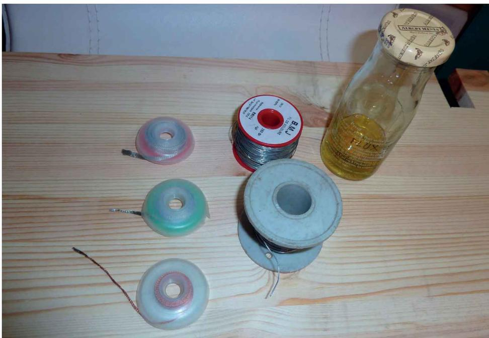
Figure 2-15. Tresse à dessouder, soudure et flux
