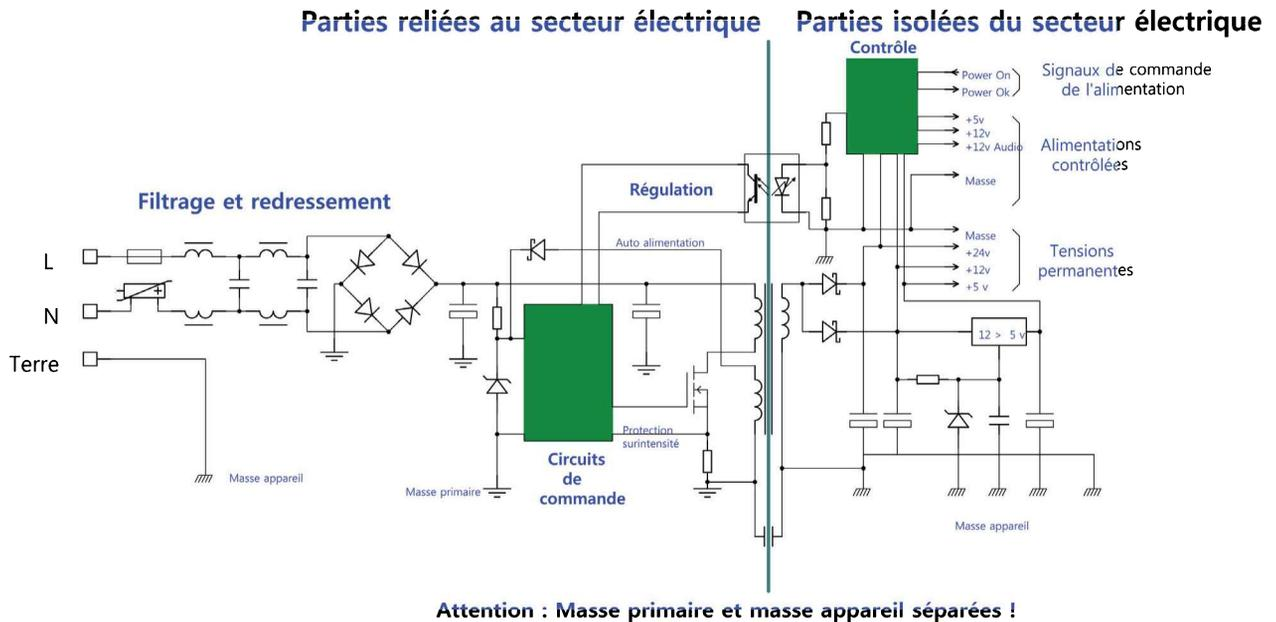
Figure 8-4. Synoptique d'une alimentation à découpage simple
