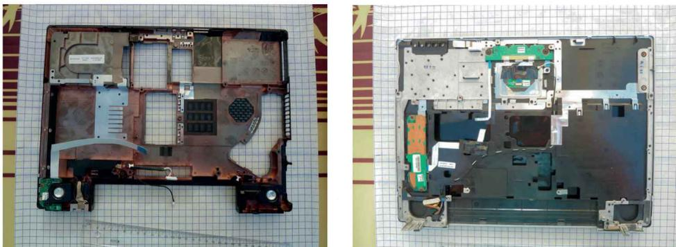
Figure 6-21. Vue des deux demi-coques d'un ordinateur portable
