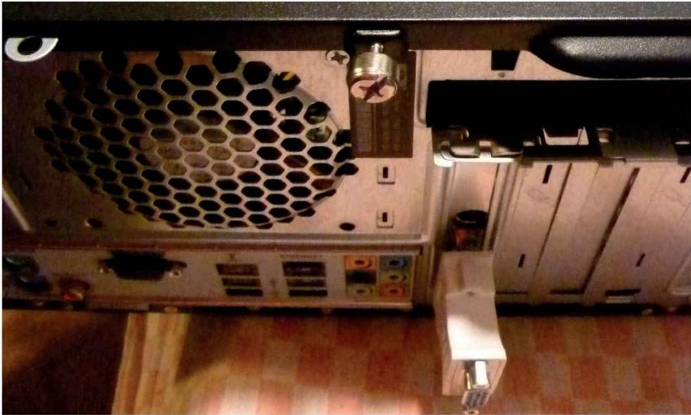
Figure 6-1. Vue arrière d'une tour, carter droit et vis de retenue
