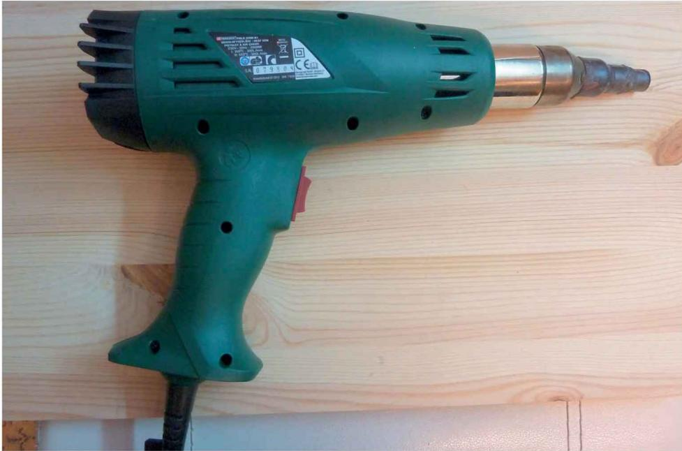
Figure 2-18. Décapeur thermique avec embout réducteur « maison »
