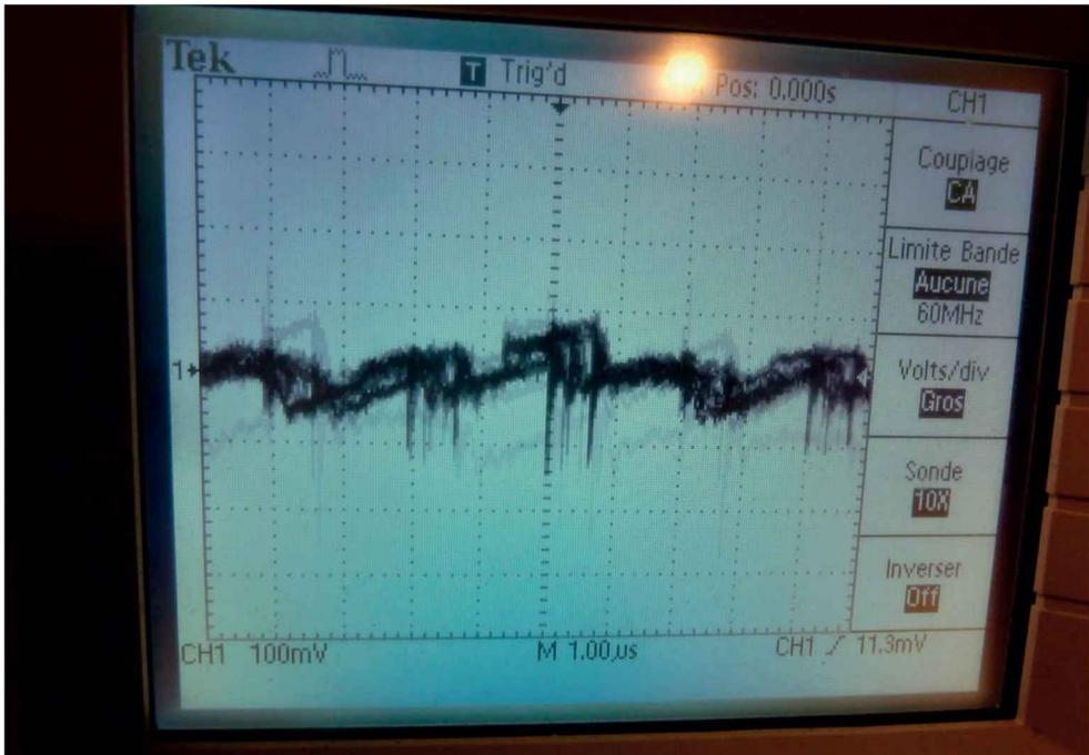
Figure 6-11. Bruit au niveau d'une ligne d'alimentation
