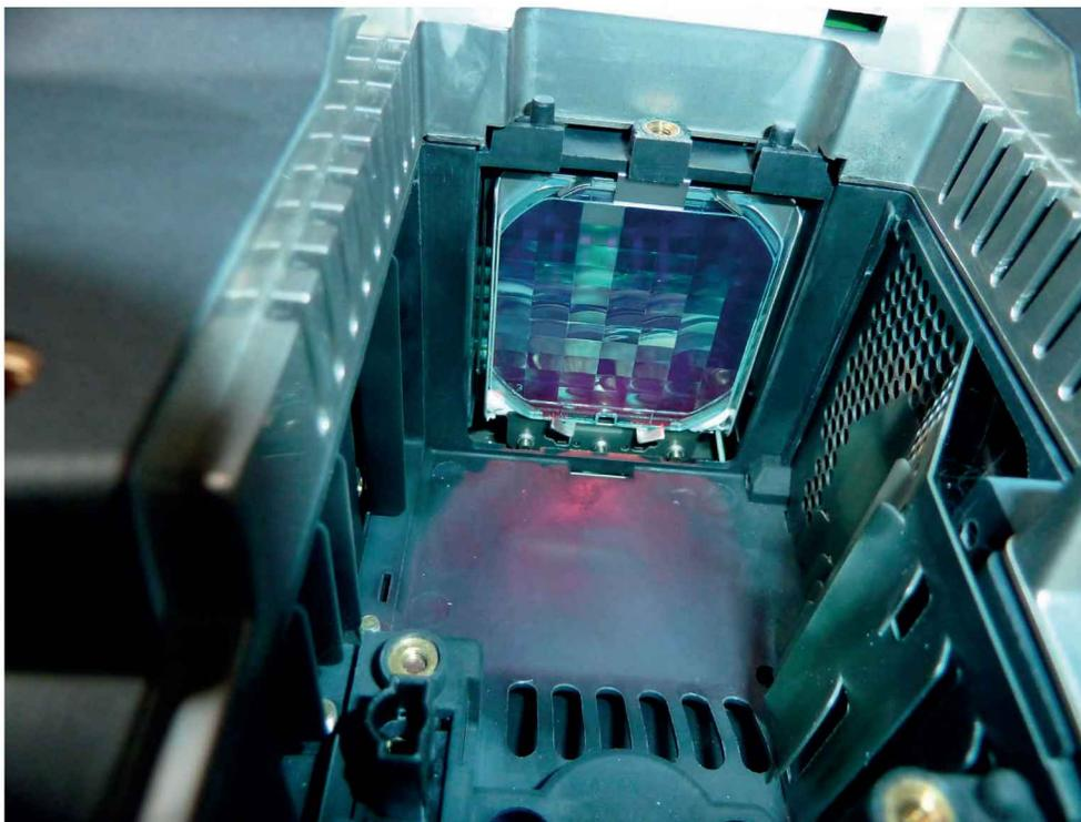
Figure 7-39. Compartiment lampe d'un Tri-LCD avec optique de diffusion de lumière
