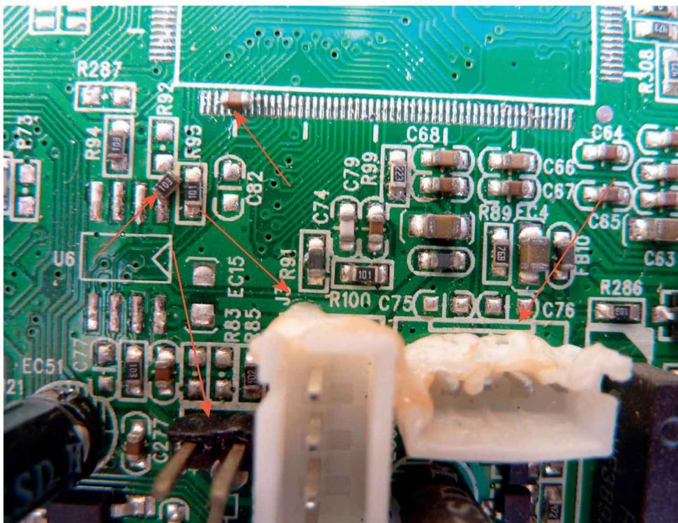
Figure 3-3. Conséquences de l'utilisation d'un matériel inadapté
