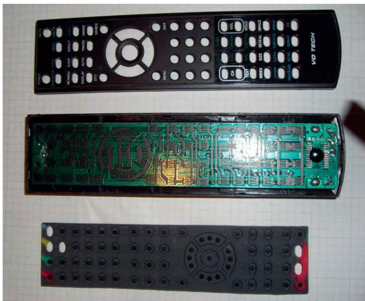
Figure 7-42. Télécommande démontée
