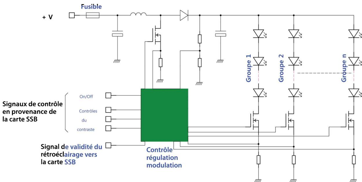
Figure 4-23. Synoptique des circuits de rétroéclairage LED
