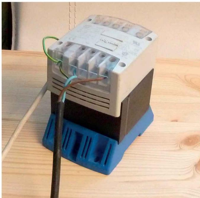
Figure 2-3. Transformateur d'isolement 220 V/220 V - 100 W
