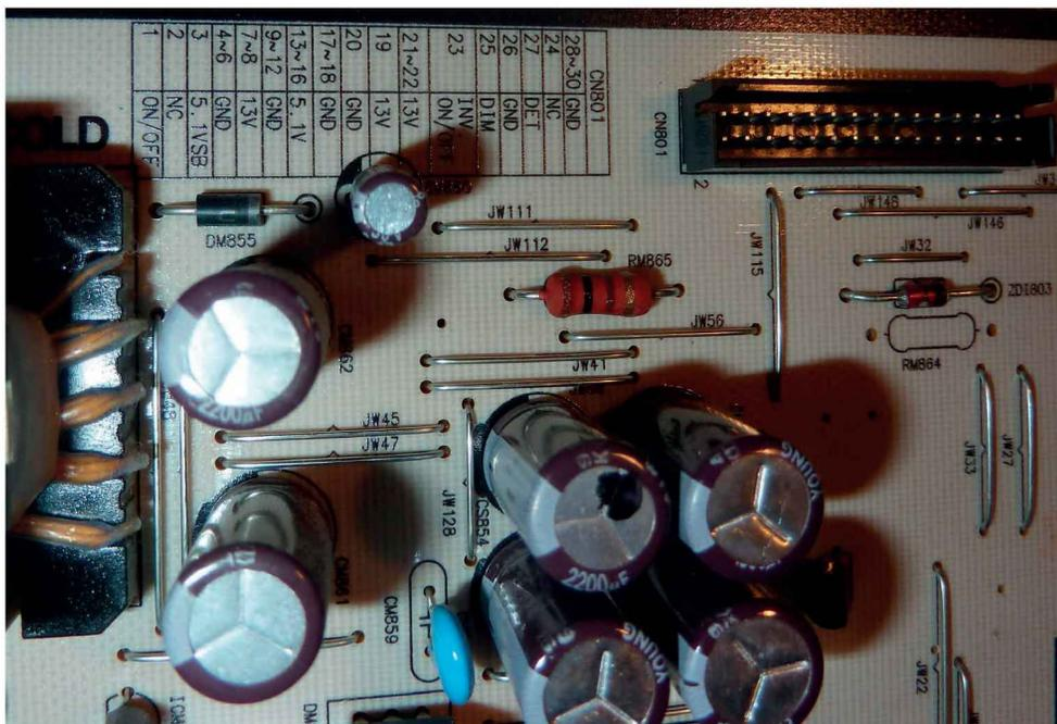
Figure 4-14. Sérigraphie du brochage du connecteur d'une alimentation
