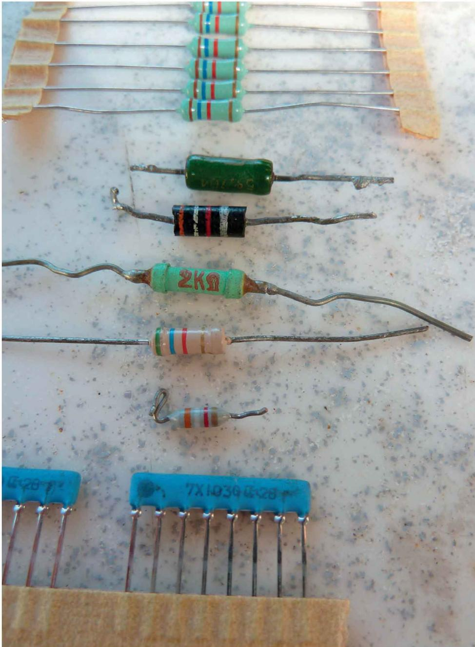
Figure 9-4. Quelques résistances et des réseaux de résistances
