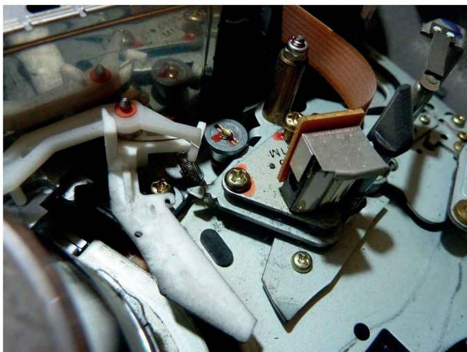
Figure 7-31. Tête d'enregistrement-lecture audio de magnétoscope VHS
