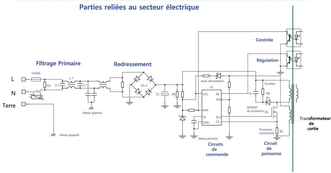
Figure 8-2. Circuit primaire d'une alimentation à découpage
