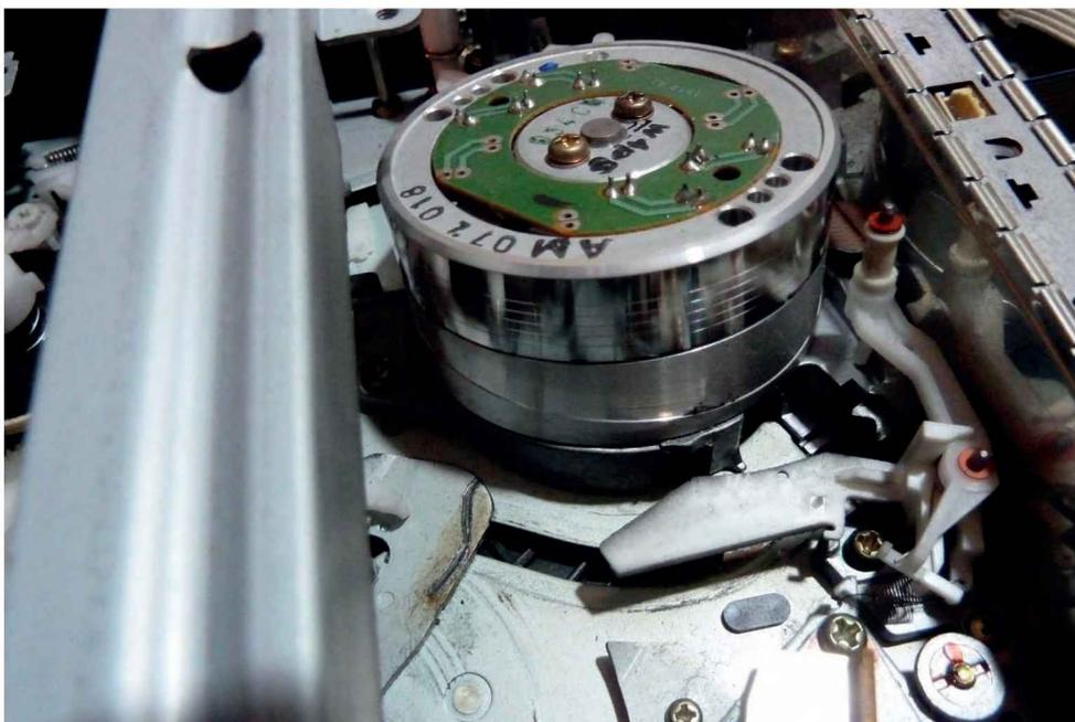
Figure 7-32. Tambour de magnétoscope VHS (lecture-enregistrement vidéo)
