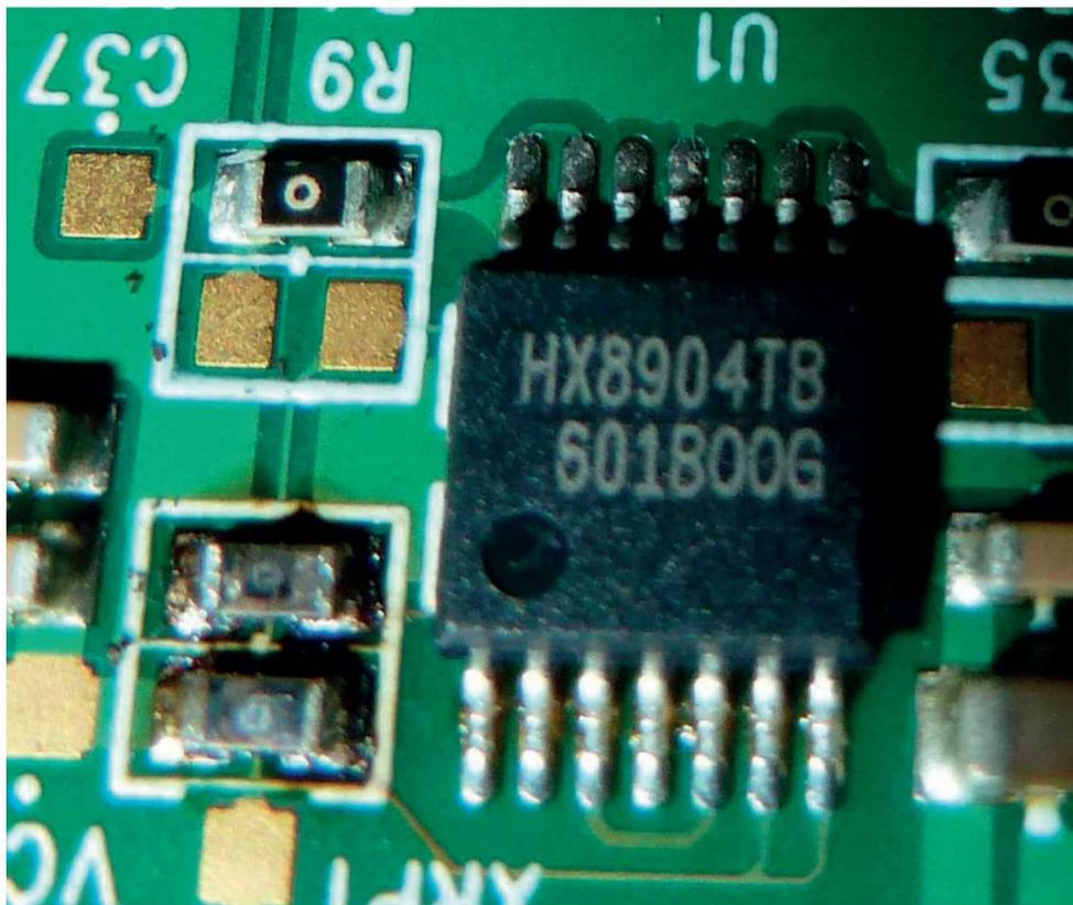
Figure 12-12. Marquage d'un circuit intégré HX8904TB (ligne 1)
