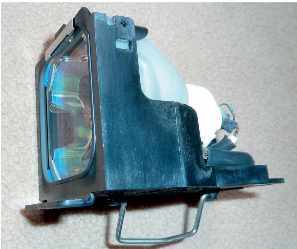
Figure 7-37. Bloc lampe d'un Tri-LCD
