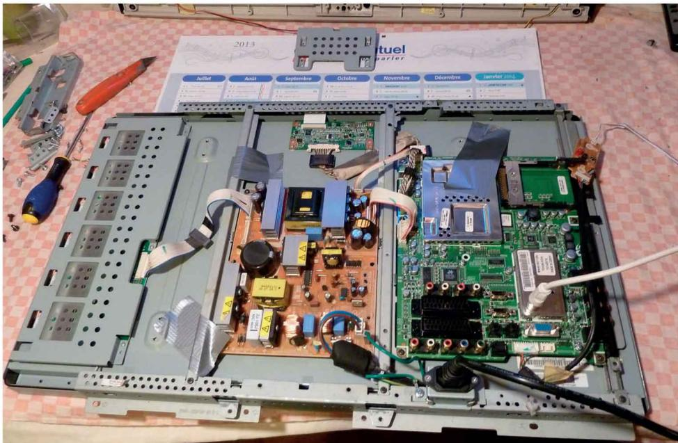
Figure 4-43. Dalle et circuits retirés du châssis de l'appareil, prêts pour test
