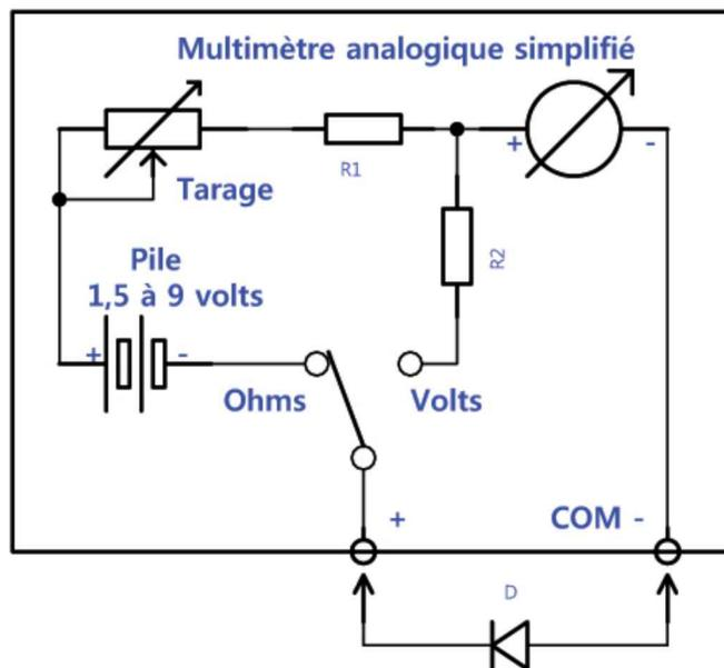
Figure 10-3. Vérification d'une diode avec un multimètre analogique
