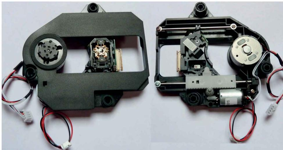
Figure 7-24. Mécanisme complet de lecteur DVD portable
