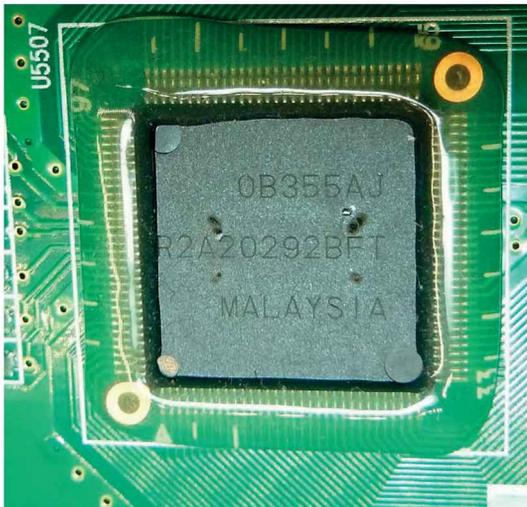
Figure 5-21. Detail d'un circuit R2A20292BFT (défectueux) soudé et protégé par colle souple
