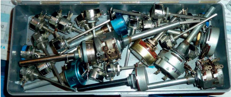
Figure 9-42. Potentiomètres rotatifs
