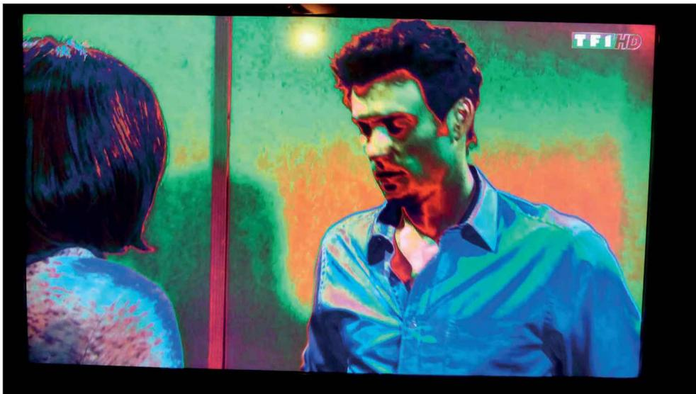
Figure 4-10. Exemple d'un défaut d'une carte T-Con
