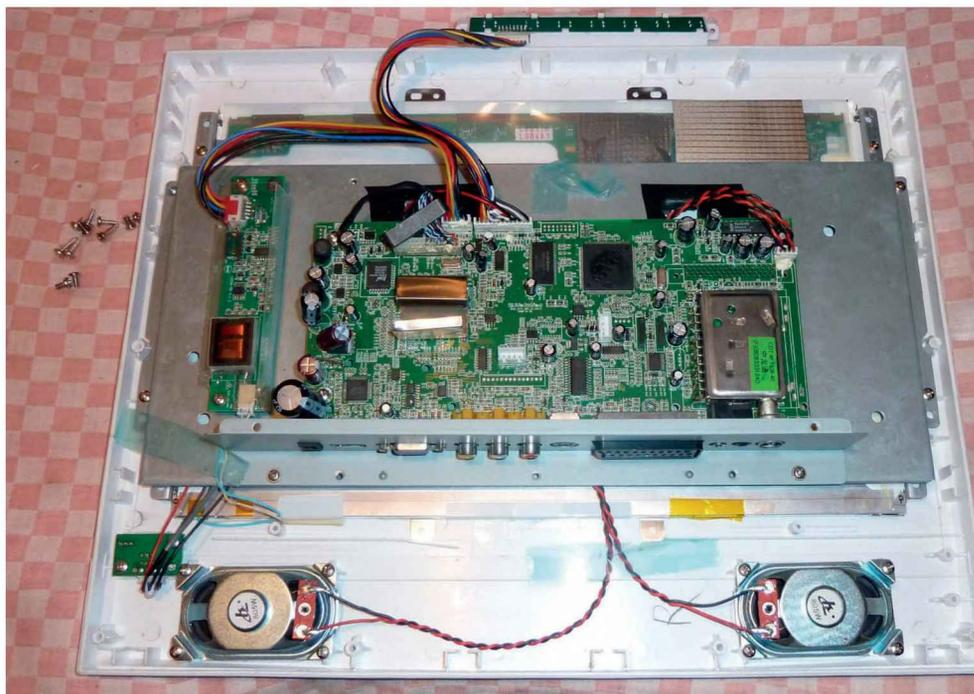
Figure 4-2. Vue intérieure d'un téléviseur de diagonale 15,4 pouces
