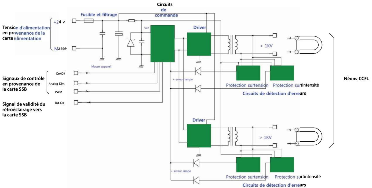
Figure 4-18. Synoptique d'un inverter séparé des circuits d'alimentation
