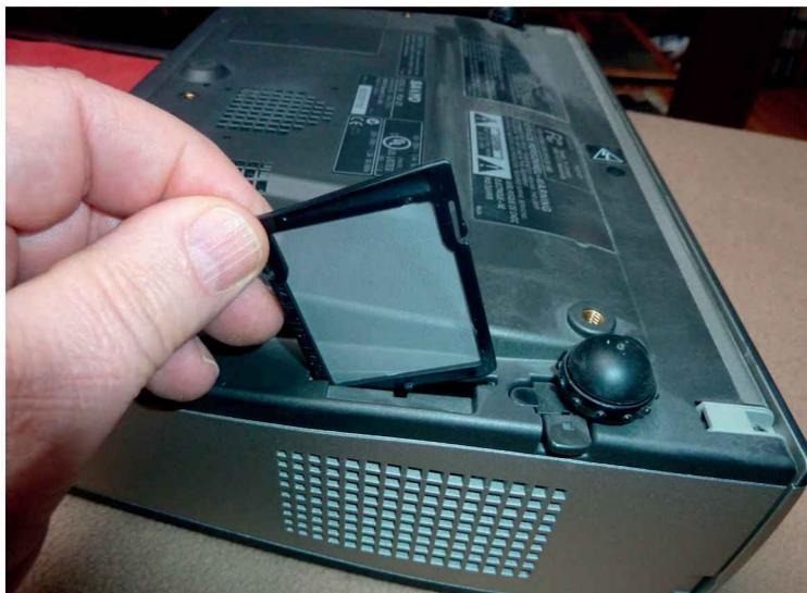
Figure 7-40. Démontage du filtre anti-poussière pour nettoyage
