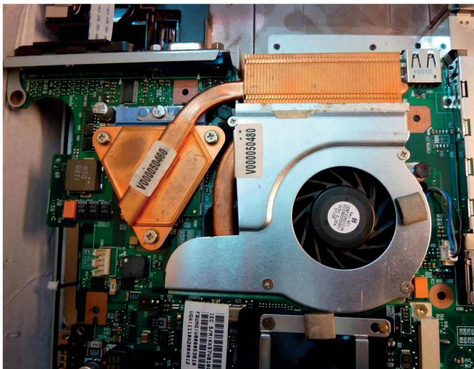
Figure 6-25. Processeur sous la partie triangulaire du refroidisseur
