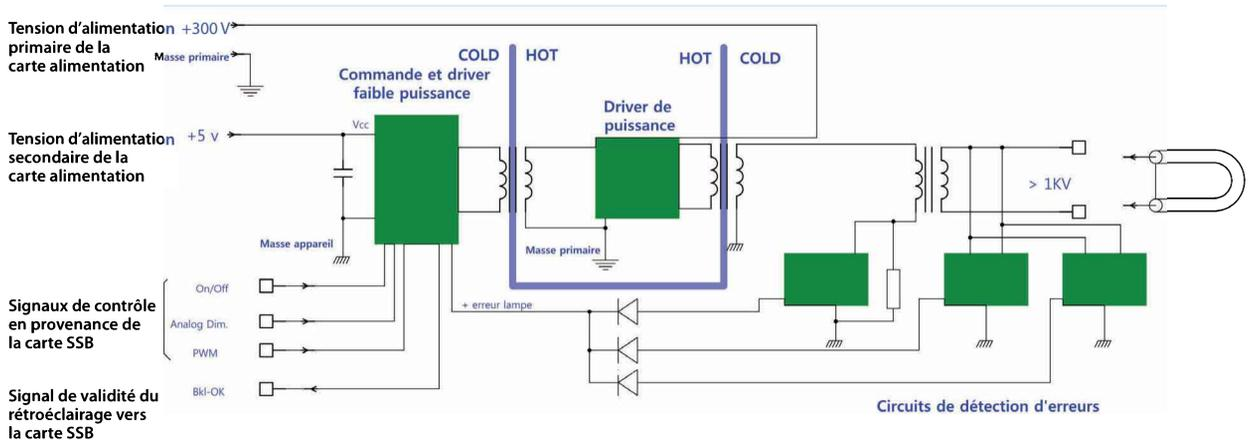
Figure 4-19. Synoptique d'un inverter dans carte alimentation
