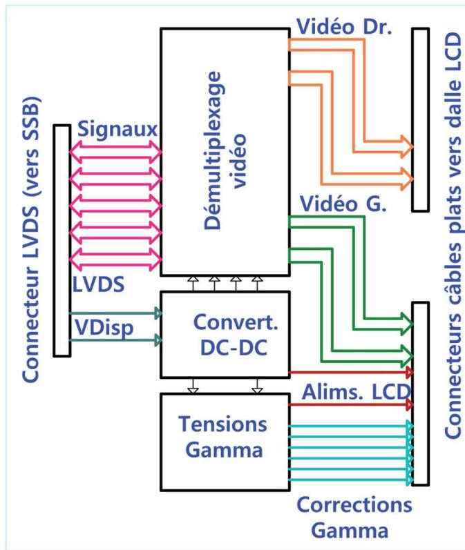
Figure 4-40. Synoptique simplifié d'une carte T-Con
