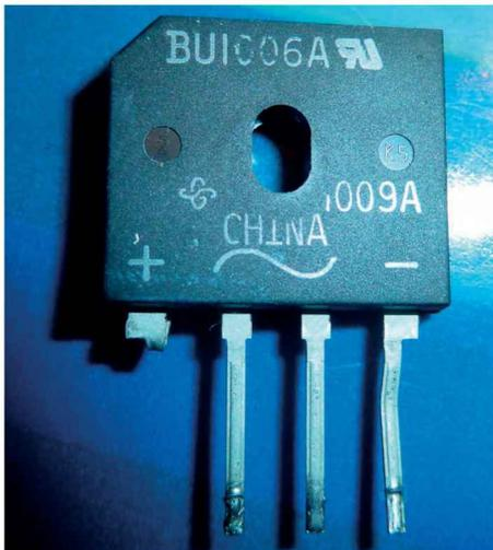
Figure 12-9. Pont de redressement à quatre diodes
