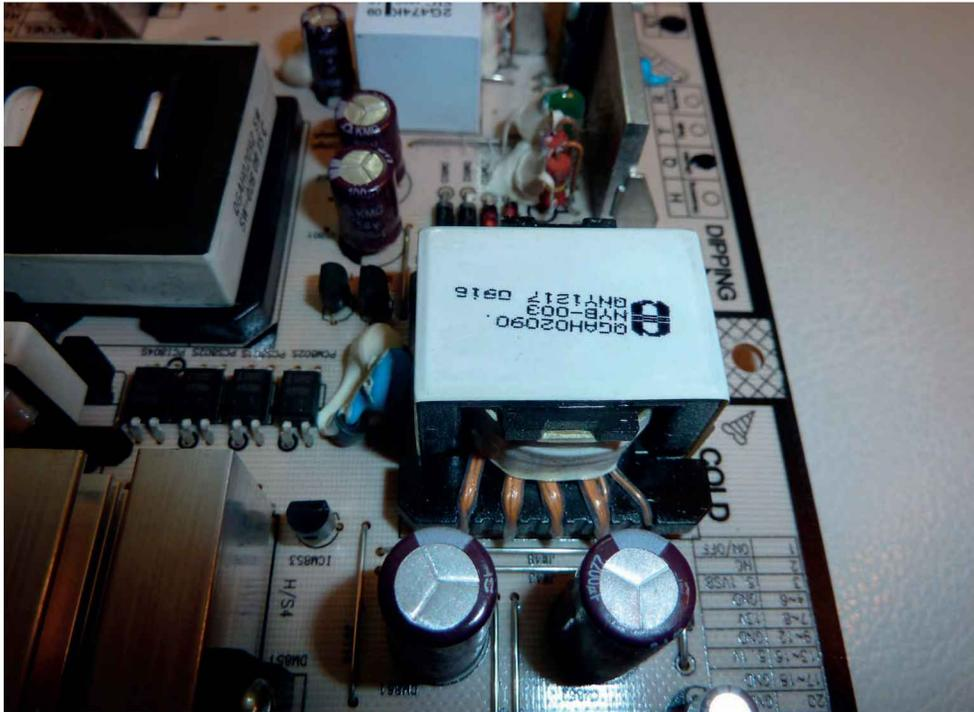
Figure 9-18. Transformateur d'une alimentation à découpage
