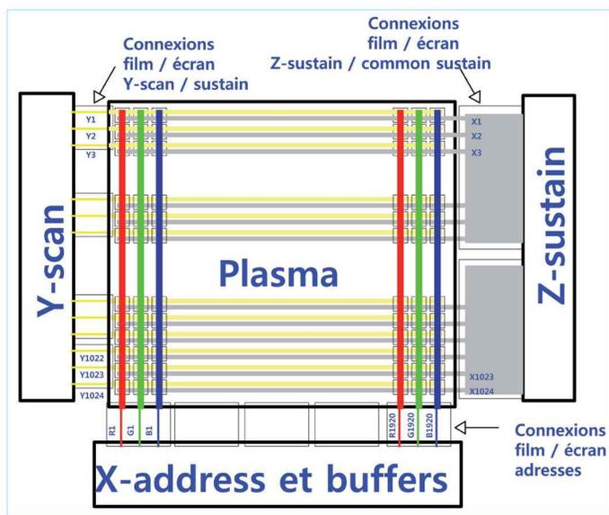
Figure 5-1. Synoptique d'un écran plasma
