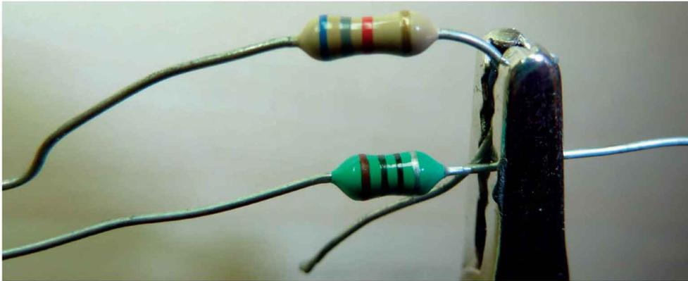
Figure 12-11. Laquelle est l'inductance, laquelle la résistance ?
