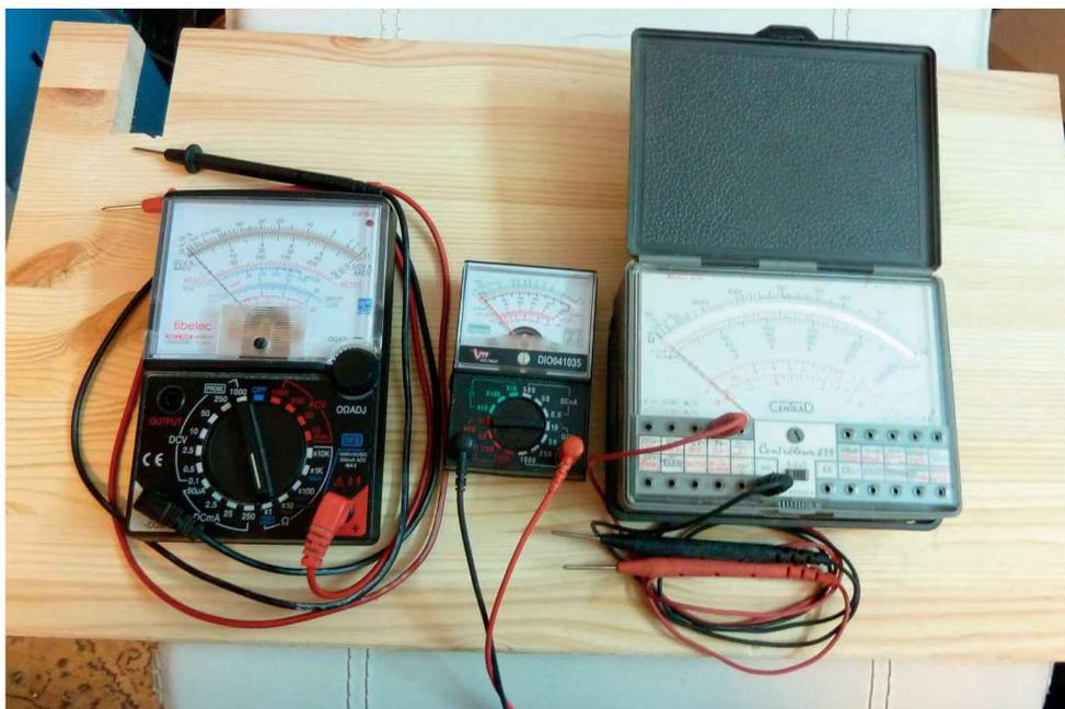
Figure 2-5. Multimètres analogiques
