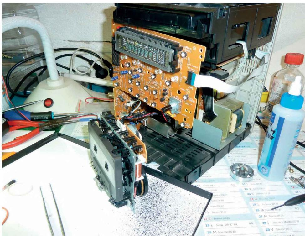
Figure 7-16. Test d'un mécanisme de lecteur/enregistreur de cassettes
