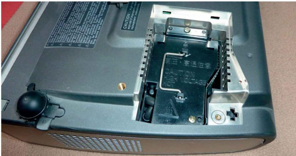
Figure 7-36. Trappe d'accès à la lampe d'un Tri-LCD
