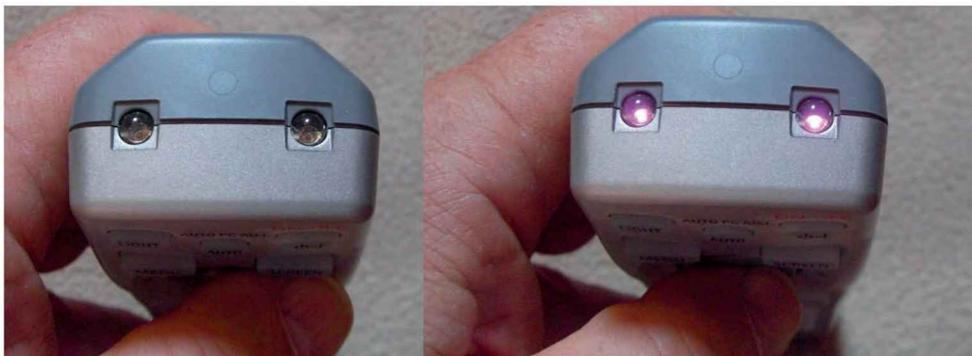
Figure 7-41. Vérification rapide d'une télécommande infrarouge
