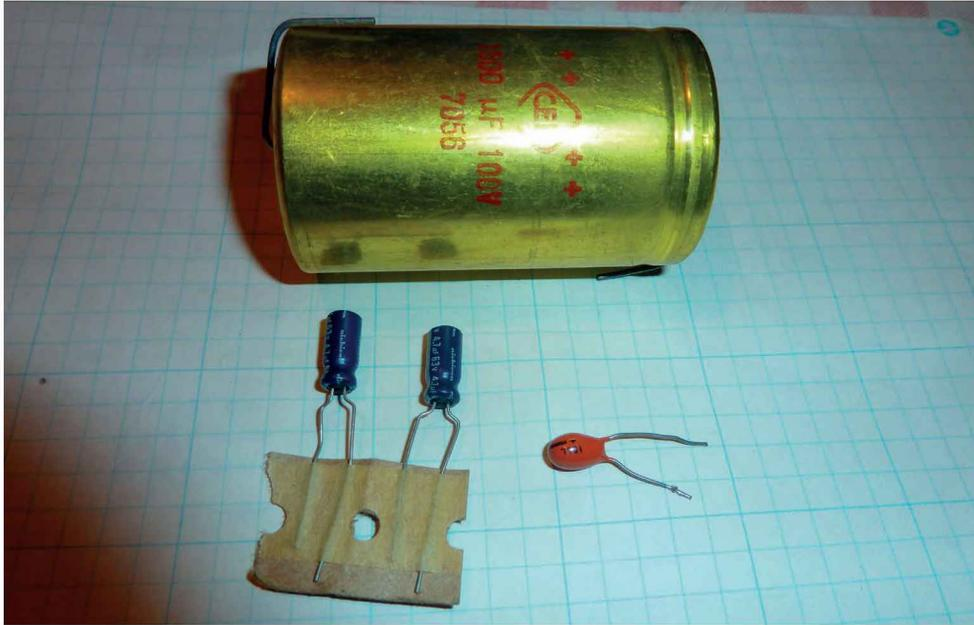
Figure 9-10. Condensateurs électrochimiques : diversité des tailles
