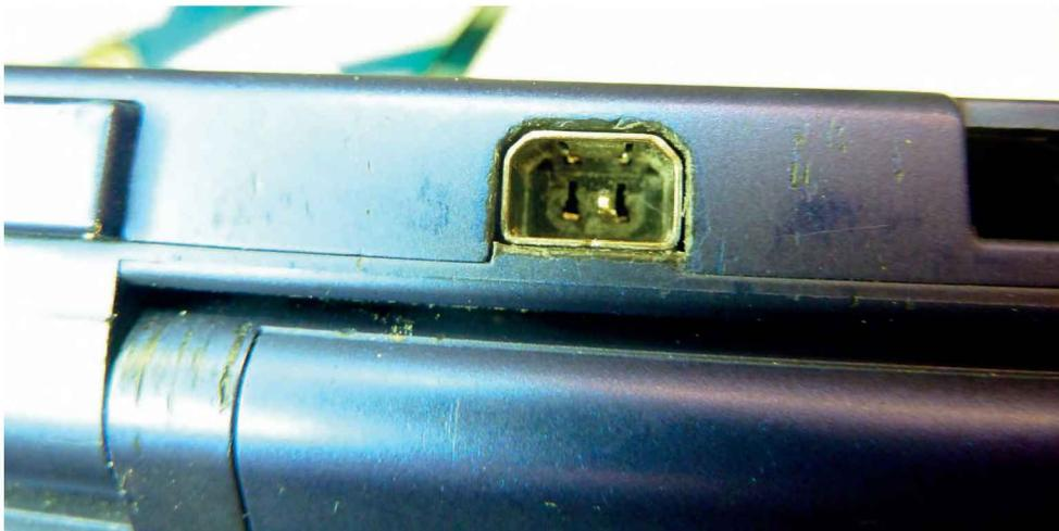
Figure 7-2. Connecteur d'alimentation d'une console de jeu détérioré
