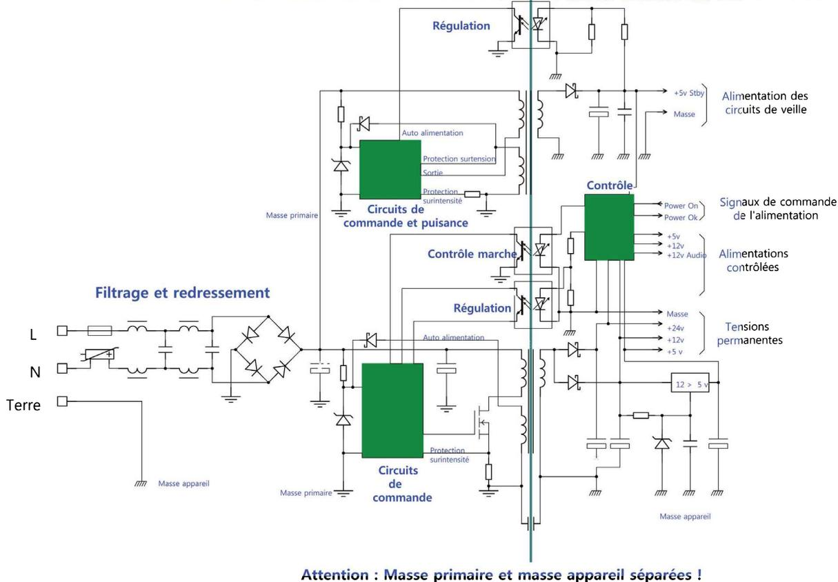
Figure 8-5. Synoptique d'une alimentation à économie d'énergie
