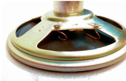
Figure 9-49. Vue des connexions d'une membrane
