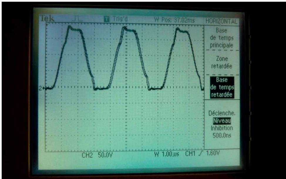
Figure 5-30. Détail des signaux de maintien Z-sustain
