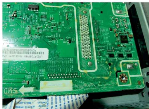
Figure 3. Traces de liquide ayant coulé sur le circuit
