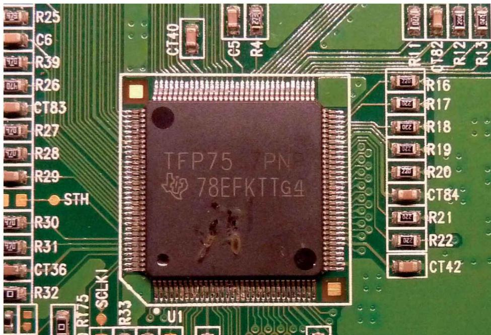
Figure 2-14. Contrôle visuel d'un composant (traces d'échauffement)
