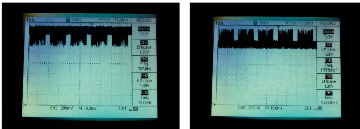
Figure 4-34. Trame vidéo d'un canal LVDS (normale et inversée, 10 ms/div. et 0,2 V/div.)
