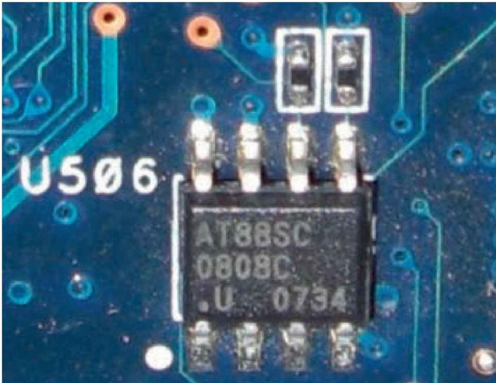
Figure 9-35. Circuit intégré de type CMS à 8 broches
