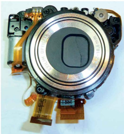
Figure 7-8. Bloc optique d'un appareil photo numérique
