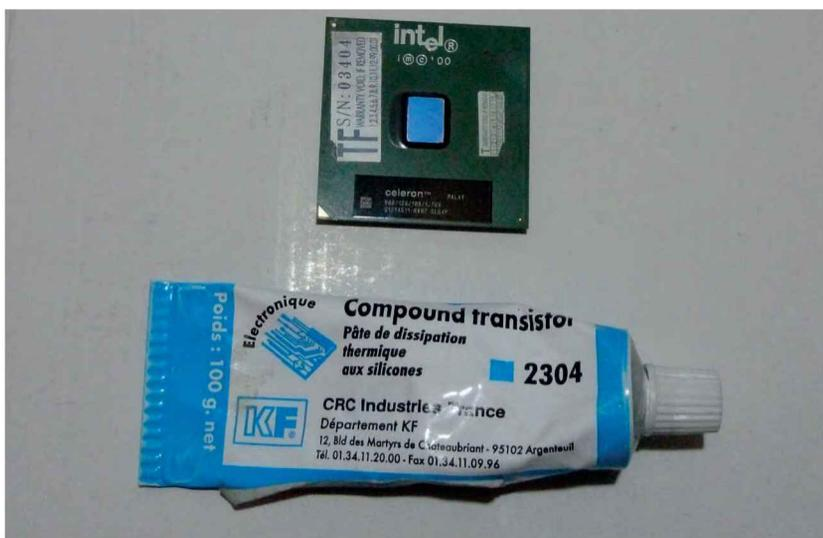
Figure 6-6. Microprocesseur et pâte thermique
