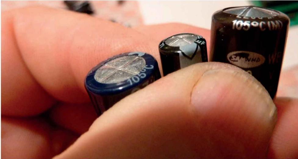
Figure 5-8. Condensateurs électrochimiques : les deux à droite sont anormalement gonflés
