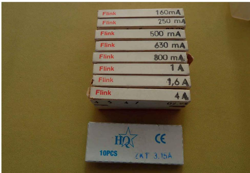
Figure 11-1. Fusibles courants en électronique
