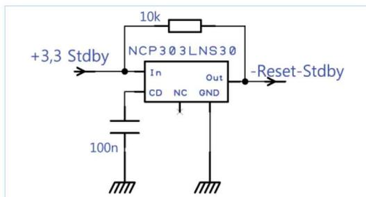
Figure 4-33. Circuit de remise à zéro initiale (reset)
