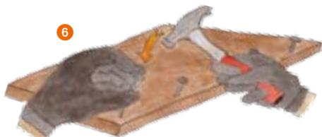
Enfoncer 4 clous longs le long du côté arrière de chaque face latérale, de l'extérieur vers l'intérieur, sans dépasser ⑥. Assembler une face latérale, puis l'autre, avec la face arrière en les clouant ensemble. ⑦
