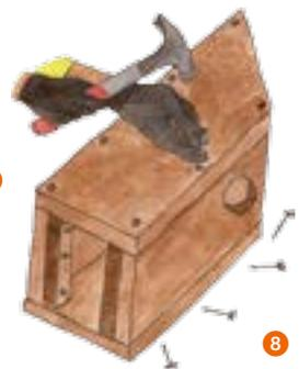
Poser le toit bord à bord avec la face arrière et y clouer la charnière ⑨ avec 4 clous courts. Puis, avec 2 clous courts, clouer chaque fixation en dessous de la charnière ⑩, de part et d'autre de celle-ci.
