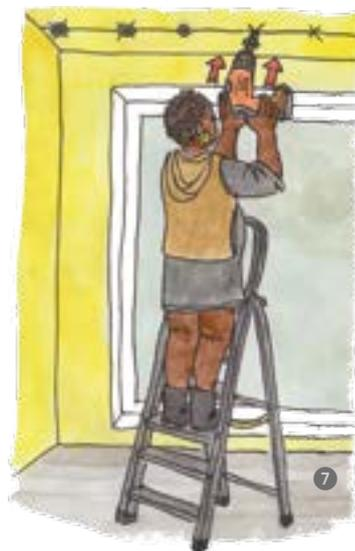
8. À deux toujours, positionner le rail sur la ligne, les trous du rail alignés sur les trous des chevilles dans le plafond. Insérer l'embout adéquat dans le mandrin de la visseuse, placer la vis dans le trou et visser en veillant à l'enfoncer complètement, de manière à ce que sa tête ne gêne pas le passage des glisseurs.
