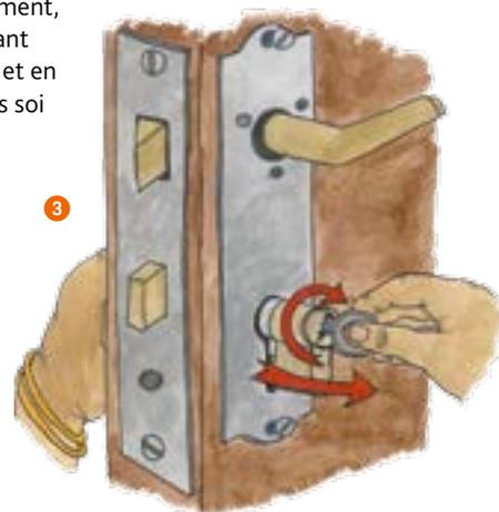
**3.** Déterminer le type de cylindre nécessaire, ainsi que ses dimensions. Si l'ancien cylindre correspond parfaitement, se baser sur ses dimensions pour choisir le nouveau. Sinon, commencer par déterminer les dimensions adéquates.
