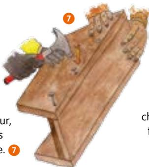
Poser la face avant entre les faces latérales et les clouer ensemble ⑧ avec 3 clous longs de chaque côté. Glisser le fond à l'intérieur afin qu'il repose sur les tasseaux. ⑧
