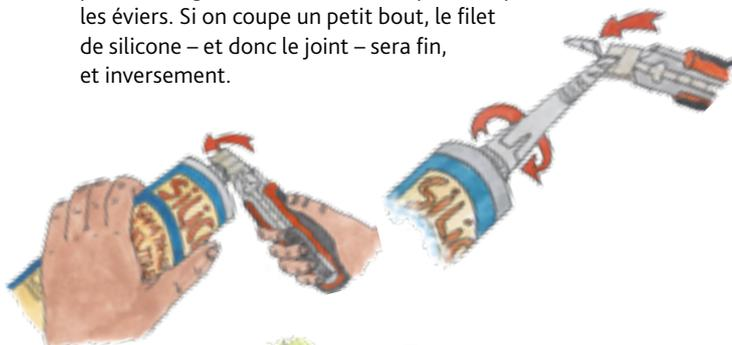
**3.** Débloquer et reculer complètement le piston du pistolet **1**, puis glisser la cartouche dans le corps du pistolet **2** et presser plusieurs fois la gâchette **3** pour faire avancer le piston, jusqu'à ce qu'il bloque la cartouche et fasse arriver le silicone dans la canule.
