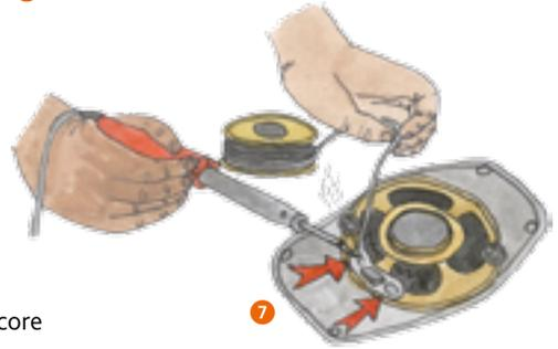
**6.** Déposer le bon fil électrique sur cette goutte durcie et poser à nouveau dessus la pointe de la panne - jusqu'à ce que la goutte se reliquéfie et englobe le fil électrique **8**. Éloigner le fer : la goutte se solidifie à nouveau, connectant ainsi les deux pièces.
